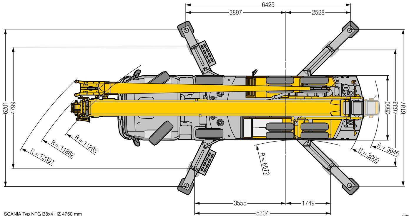
SCANIA Typ NTG B8x4 HZ 4750 mm
